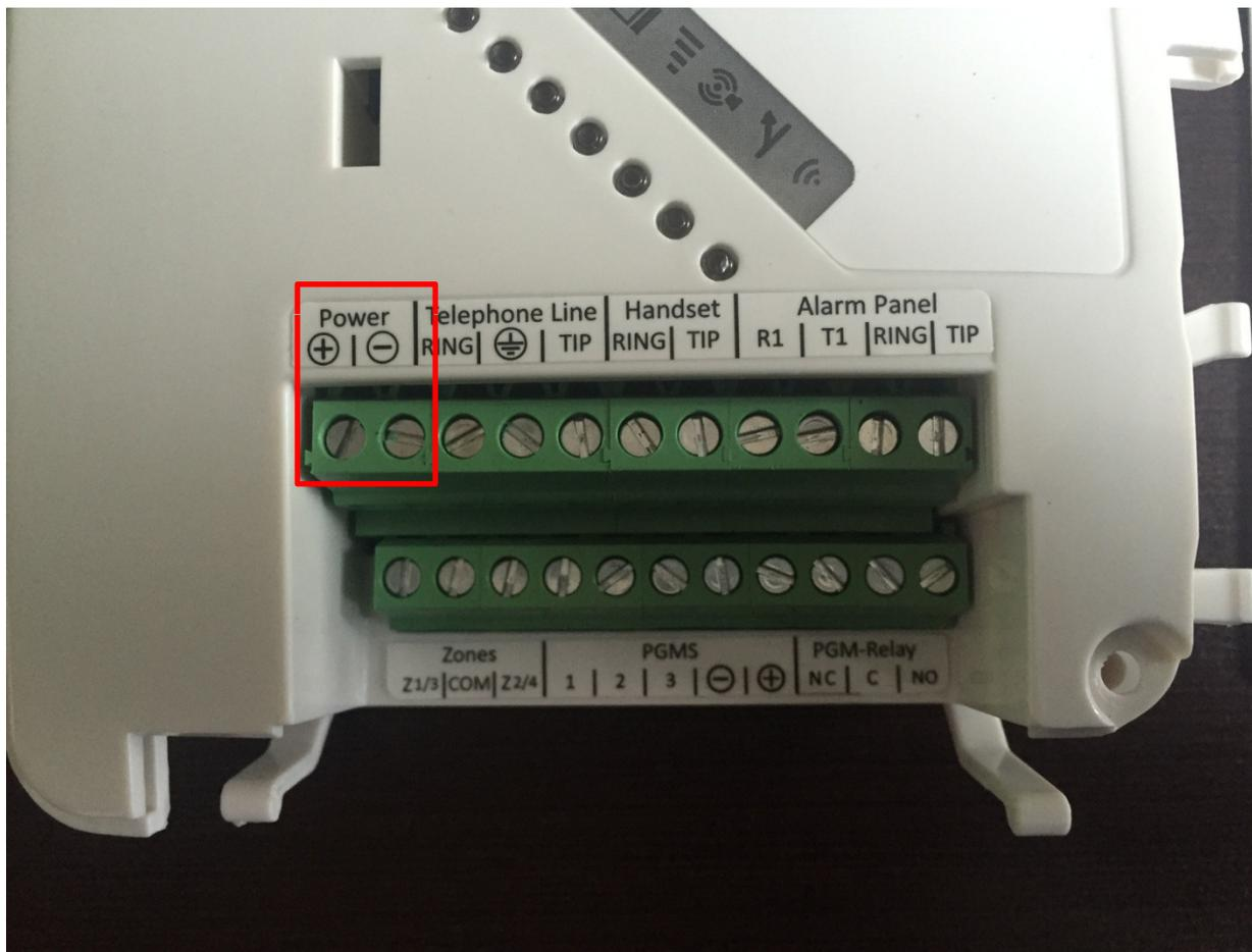
Conectar la alimentación eléctrica en los bornes "Power" cuidando la polaridad.
