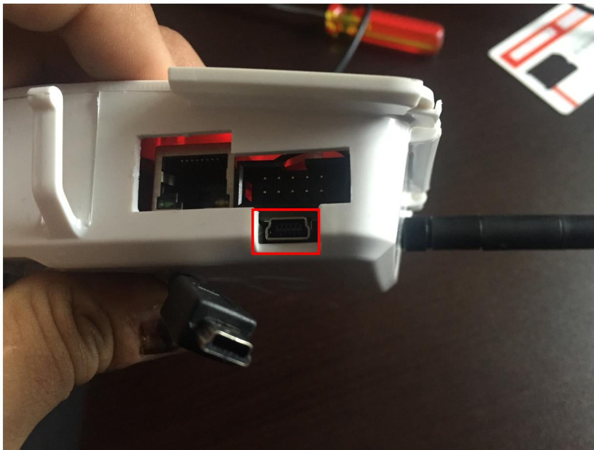
Conectar el cable USB en el puerto del GPRS y posteriormente en uno de los puertos de nuestra computadora.
